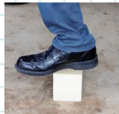
完成した硬質ウレタンは踏んでも変形しないほど硬い
